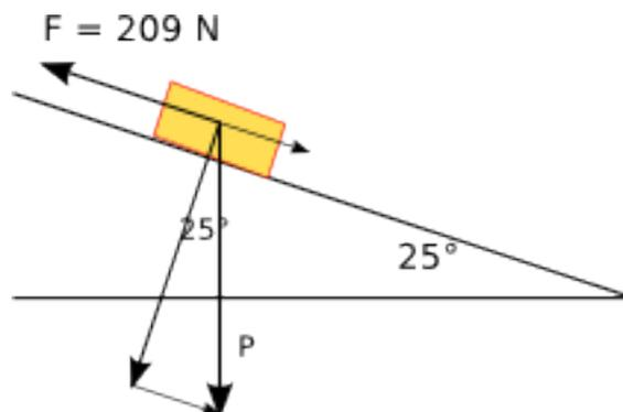
**Soluzione.** Il peso della cassa vale  $P = mg = 25.0 \text{ kg} \cdot 9.8 \frac{\text{m}}{\text{s}^2} = 245 \text{ N}$ . La componente parallela è
