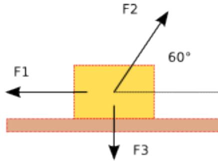
**Soluzione.** La cassa si muove lungo la direzione orizzontale scorrendo senza attrito sul piano. Calcoliamo la risultante delle tre forze lungo la direzione orizzontale, supponendo positivo lo spostamento verso sinistra
