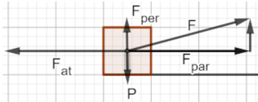
**Soluzione.** Il blocco si muove a velocità costante e ciò comporta che la forza d'attrito, in modulo, è pari alla componente parallela della forza applicata al blocco (vedi figura). Calcoliamo  $F_{par}$  sapendo che l'angolo che  $F$  forma con l'orizzontale è di  $15^\circ$
