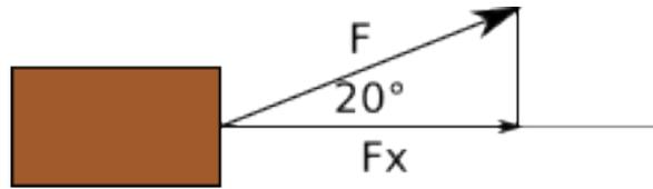
**Soluzione.** La figura sopra descrive il modo in cui si deve scomporre il vettore che descrive la forza applicata. Solo la componente  $F_x$  compie lavoro nello spostamento orizzontale (sul pavimento) della cassa; la componente verticale forma un angolo retto con la direzione dello spostamento e il prodotto scalare tra la forza e lo spostamento risulta in questo caso nullo. Calcoliamo il lavoro fatto dal facchino tramite la forza  $F_x$
