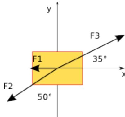
**Soluzione.** il corpo si muove nel piano  $xy$ . Calcoliamo le componenti delle forze lungo i due assi
