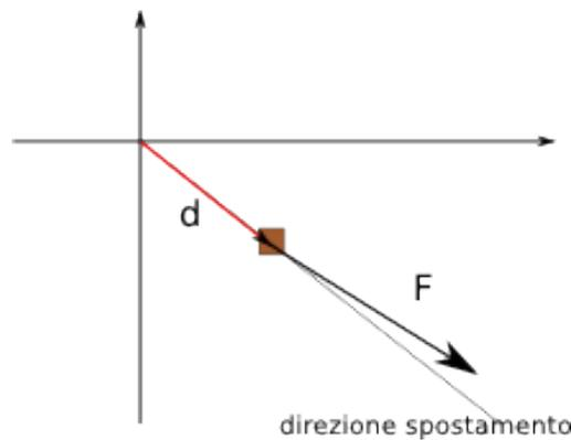
**Soluzione.** La figura rappresenta, rispetto ad un piano cartesiano arbitrario, i vettori forza e spostamento. In questo caso è necessario calcolare la componente della forza lungo lo spostamento. Lo spostamento forma un angolo rispetto all'orizzontale (asse  $x$ ) (prendiamo positivo il verso orario)
